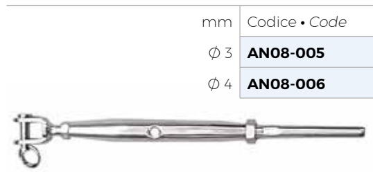
Tenditore terminale a forcella per cavo Ø 3 | 4 mm in acciaio inox AISI 316. Filettatura interna M6 Turnbuckle fork-terminal for wire cable Ø 3 | 4mm AISI 316 stainless steel. M6 Internal thread
